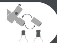
**Gestión de la distribución de cápsulas** (Ø28 a Ø36) mediante cambio de **cubiletos a medida e intercambiables**
