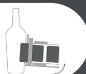
**Precisión del revestimiento en botellas cónicas** mediante **inclinación de los puestos de etiquetado**
