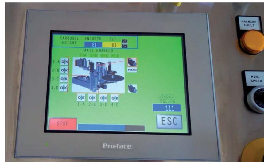
Stazione con 4 assi controllati da servomotori
