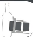
Precisión del revestimiento en botellas cónicas mediante inclinación de puesto
