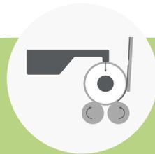
Mantenimiento de los productos ligeros durante el etiquetado mediante la utilización de un brazo de presión adicional
