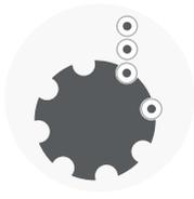
**Inmovilización de las botellas durante la transferencia entre los distintos puestos de la máquina** por una estrella de 8 puntas
