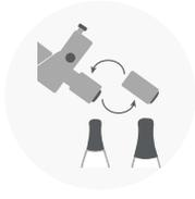
**Gestión de la distribución de cápsulas** (Ø28 a Ø36) mediante cambio de **cubiletes a medida e intercambiables**
