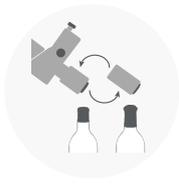
**Gestión de la distribución de cápsulas** (Ø28 a Ø36) mediante cambio de **cubiletes a medida e intercambiables**
